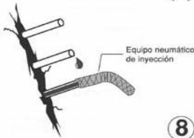
Equipo neumático de inyección
