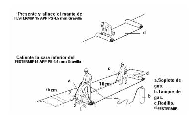
Caliente por medio de soplete de gas (especial para prefabricados) la cara inferior de una sección del manto hasta fundir la película transparente de polipropileno que trae integrada, y proceda de inmediato a asentarla contra la superficie, presionando ligeramente a efecto de que suelde por vulcanización. Repita esta operación a medida que va extendiendo el rollo de FESTERMIP 15 APP PS 4.5 mm. GRAVILLA
